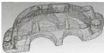
图 2 减速箱箱盖表面的数据点云
