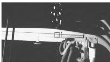
图5 基于原理No. 13(反向)由目标内向外搜索边缘
