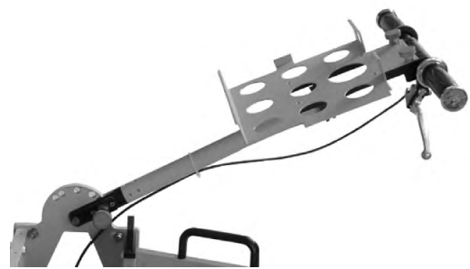
图 2 轨检小车主推换向装置
