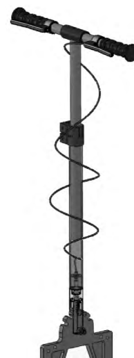
图6 轨检小车手推换向装置改进方案
